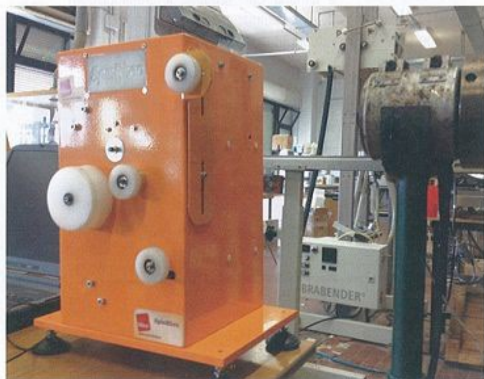
Fig. 1 - La nuova apparecchiatura SpinRheo (Idealnstr, Italia) permette di misurare le proprietà reologiche in flusso elongazionale non isoterma e, contemporaneamente, preparare le miscele e raccogliere le fibre prodotte a diversi valori del rapporto di stiro
